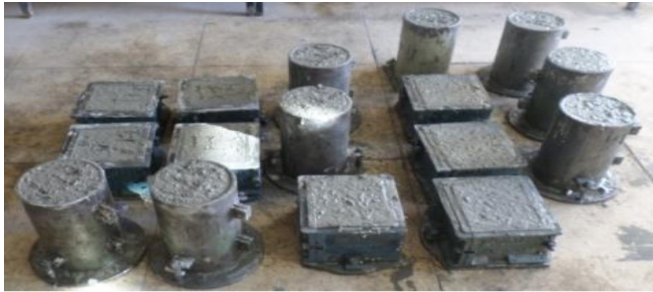
شكل 8 خلط الخرسانة و اعداد و صب العينات.
