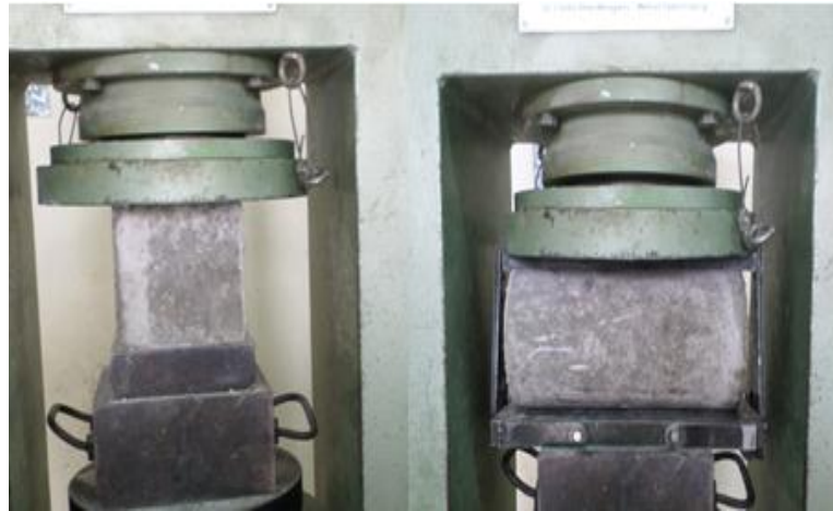
شكل 9 شكل العينات عند اجراء اختباري الضغط و الشد الغير مباشر.
